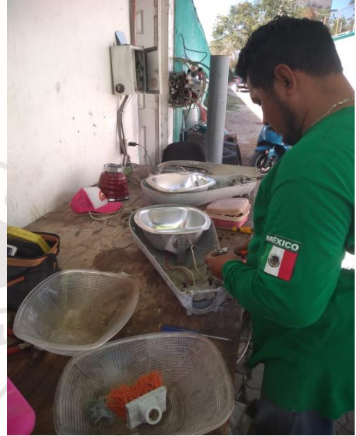
BODEGA DE ALUMBRADO, SE REALIZA LA LIMPIEZA DE CARCASA TIPO OVIS
