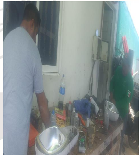
BODEGA ALUMBRADO , SE ARMARON LAMPARAS EN BODEGA DE OV-15 CON BALASTROS, CON FOCOS DE 250W EN ALMACEN
