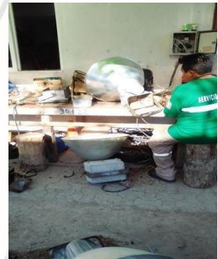
Se revisan reflectores para reparación en bodega de alumbrado.
